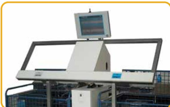
**Poste tunnels RFID** pour lecture dynamique de pochettes et sacs navettes et le contrôle du dispatching des flux.
