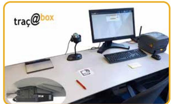
**Poste fixe RFID** équipé de la Traçabloc, solution plug & play pour la réception et l'expédition rapide de pochettes et sacs navettes
