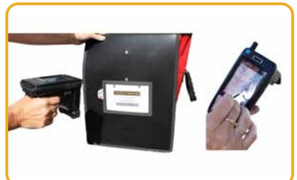
**Terminal portable durci** pour les tournées intégrant un appareil photo et un double système de lecture code à barres et de lecture-écriture RFID
